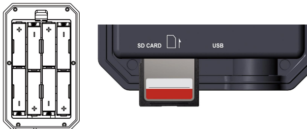
Figura 5: Instalación de baterías y tarjeta SD
